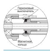
Магнитное поле кольца, которое установлено на гайке, активирует контакт геркона, закрепленного на защитной трубе с помощью зажима. Положение ограничителей вдоль трубы легко регулируется.
