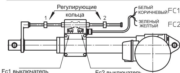
Два электрических ограничителя, установленных внутри герметичной пластиковой коробки, активируются с помощью двух регулируемых колец через воротник вала
